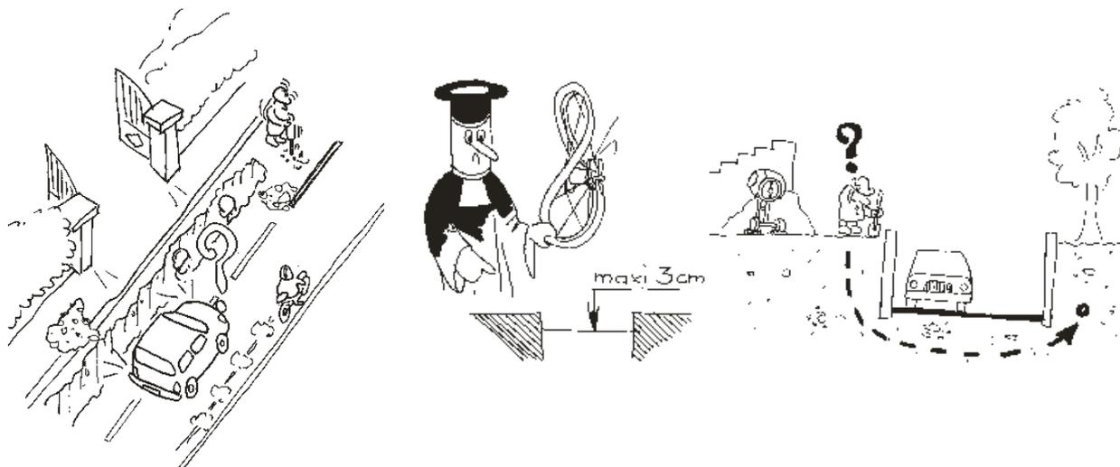
La tranchée ne pourra pas être exécutée si le revêtement de la tranchée a moins de 3 ans d'âge. Dans ce cas vous devrez recourir à des techniques spécifiques non destructrices pour la chaussée, telles que le forage ou le fonçage.
