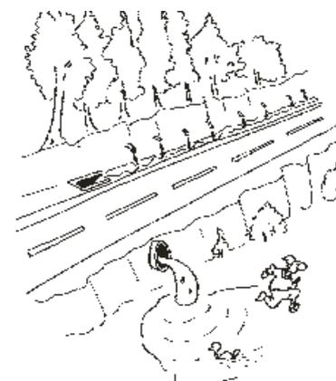
Si vous devez créer une importante surface imperméabilisée, assurez-vous de prendre toutes les dispositions nécessaires pour éviter les dégâts à la route et aux autres riverains en cas d'orage. Si un afflux massif d'eau sur la route crée un danger, votre responsabilité peut être recherchée.
