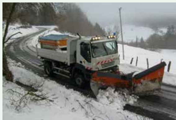
Camion équipés en saeuse et outils de raclage
